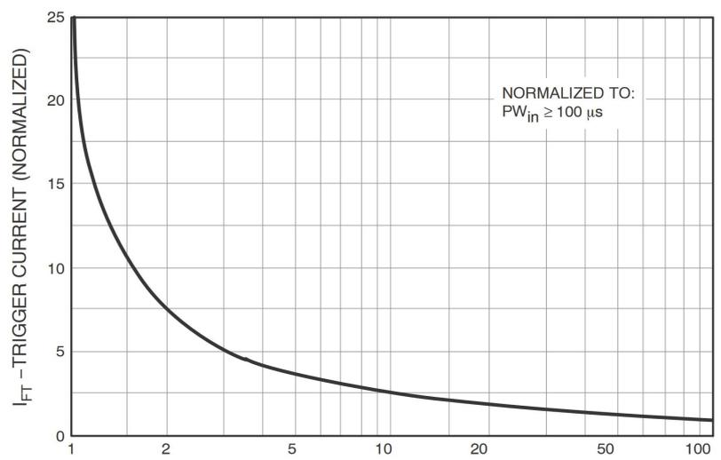
图4: 触发电流 VS 脉宽
