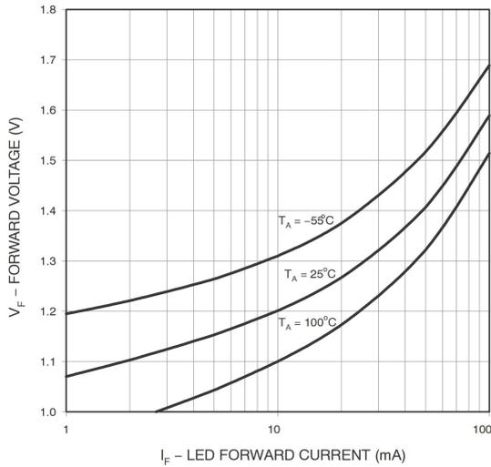
图 1: 正向电压 VS 正向电流
