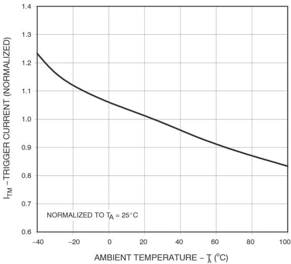
图3: 触发电流VS 温度
