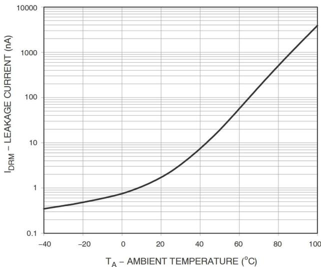
图 5: 抑制状态漏电 VS 温度
